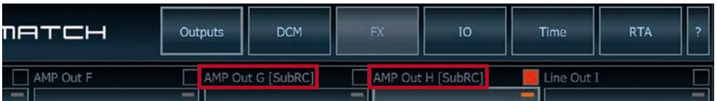
Bei **aktiviertem** VCP hingegen wird die Subwoofer-Fernbedienung den Ausgangskanälen zugeordnet, welche im „Virtual to Output Routing“ mit einem der beiden virtuellen Subwoofer-Signalen versorgt werden („Subwoofer 1“ oder „Subwoofer 2“). Dies kann jede beliebige Kombination an Ausgangskanälen sein.
